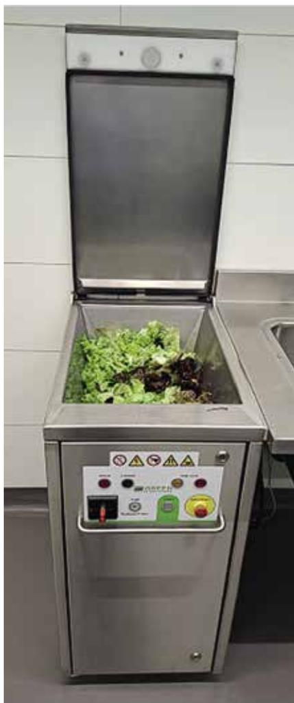
← In diesem Gerät, dem Biomaster, werden die Rüstabfälle und Speisereste aus dem ganzen Haus gesammelt. Ist der Trichter voll, wird der Deckel geschlossen und der integrierte Häcksler zerkleinert nach Zugabe von etwas Wasser die Abfälle zu einem groben Brei.
